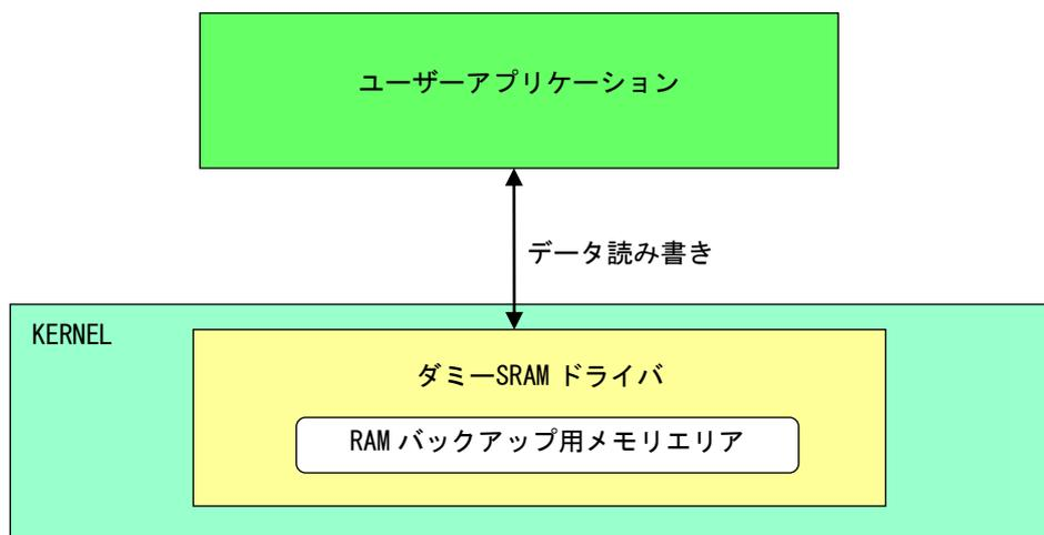
図 4-7-2-1. ダミー-SRAM ドライバ
