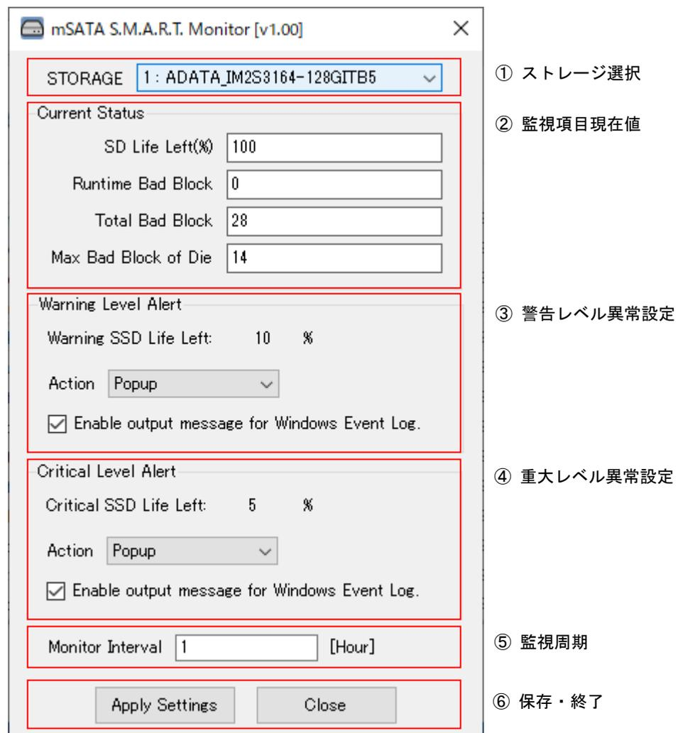
図 2-14-3-4. S.M.A.R.T. Monitor Tool 設定画面
