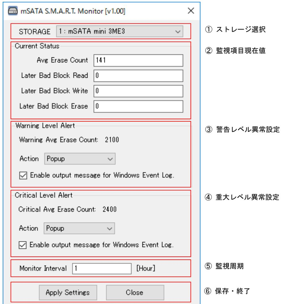
図 2-14-3-5. S.M.A.R.T. Monitor Tool 設定画面
