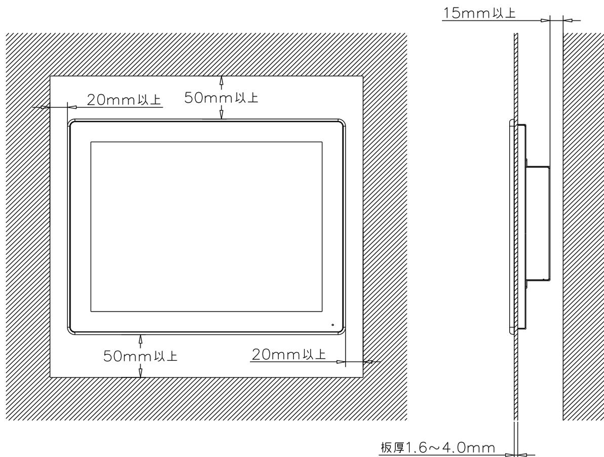
放熱のため、他の機器は本体より表記寸法以上離して設置してください。(上図参照)
