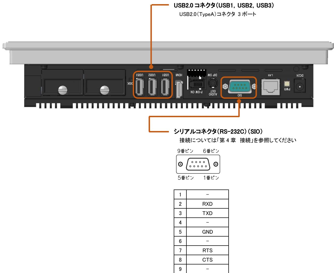
適合コネクタ : HDEB-9S(05) (ヒロセ電機製)
