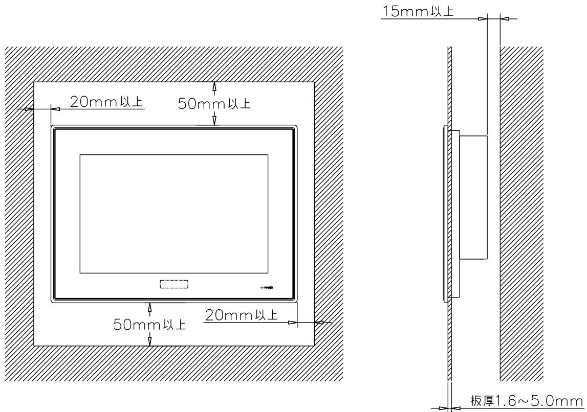
放熱の為、他の機器は本体より表記寸法以上離して設置してください。(上図参照)
