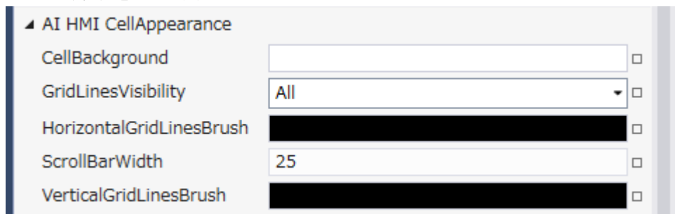
図 29-2-1 AI HMI CellAppearance プロパティ
