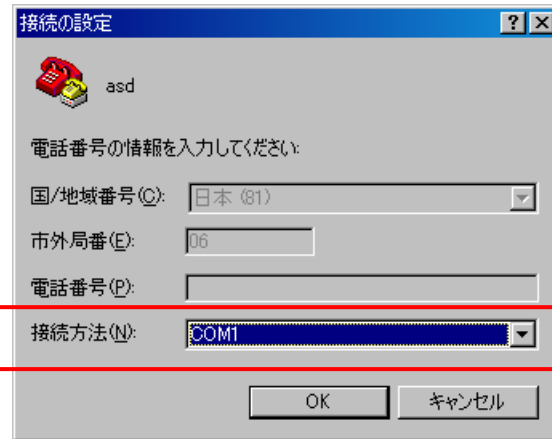
図 3-5-3. 接続の設定 (接続方法)
