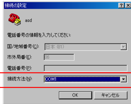
図 3-5-3. 接続の設定 (接続方法)
