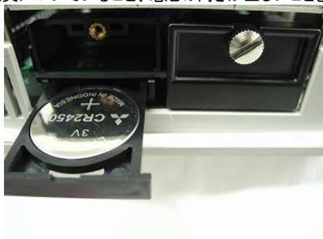
4. メインストレージカバーを元の位置に押し込み、ツマミを回してとめます
