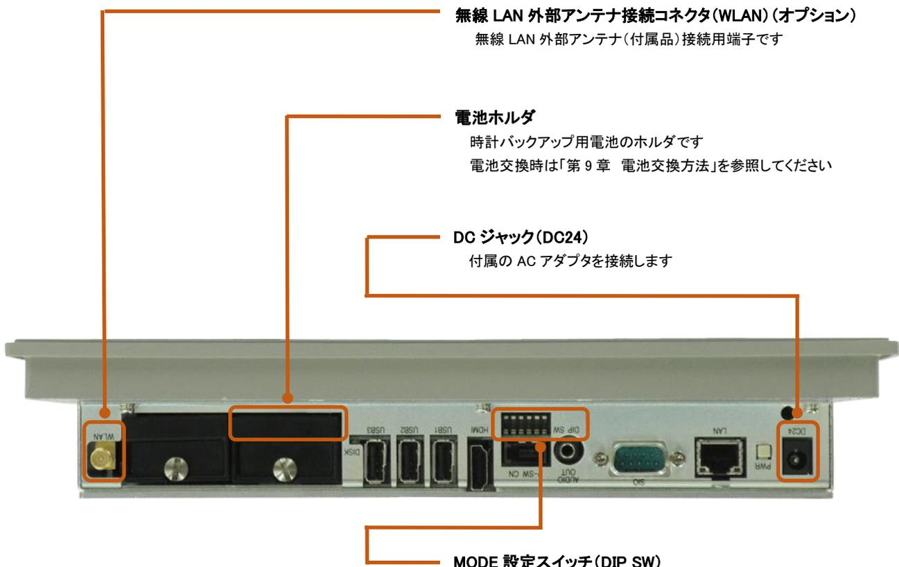
**無線 LAN 外部アンテナ接続コネクタ(WLAN) (オプション)**
