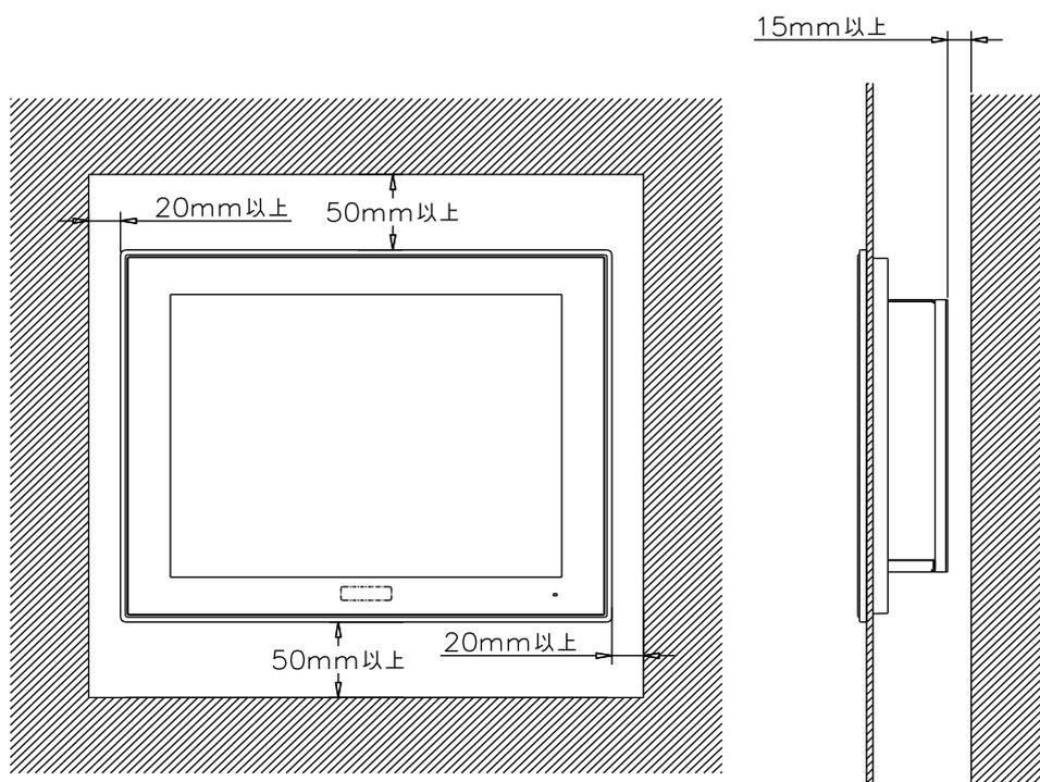
放熱の為、他の機器は本体より上下側は 50mm 以上、左右は 20mm 以上、背面側は 15mm 以上、離して設置してください。
