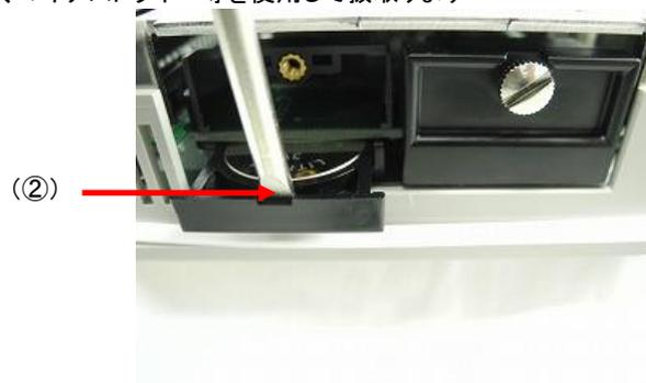
3. 電池ホルダから古い電池をはずし、新しい電池を付けて元の位置に差込んでください
