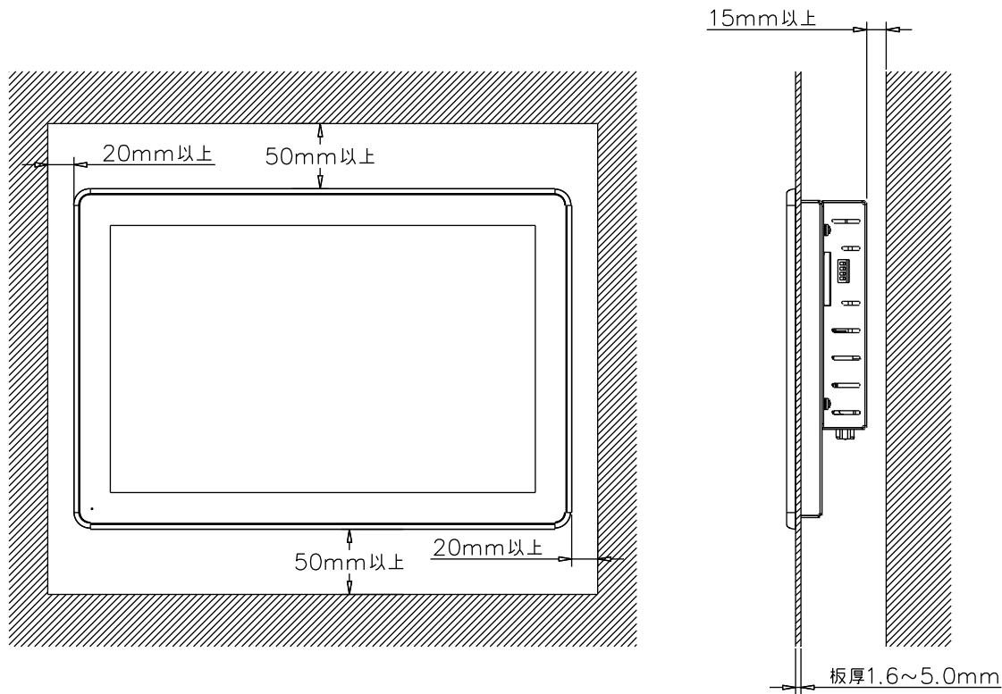
放熱のため、他の機器は本体より表記寸法以上離して設置してください。(上図参照)
