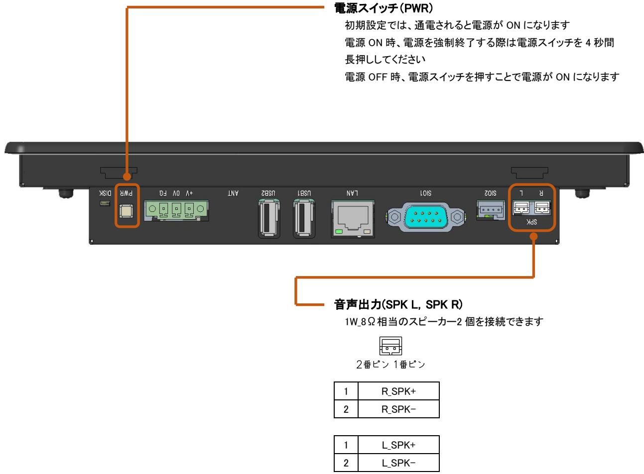
コネクタ : S2B-PH-K-S(LF)(SN)(日本圧着端子製)
