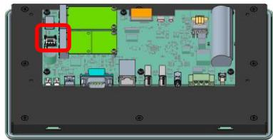
3. SIMカードソケットのフタを矢印方向にスライドさせるとロックが外れます
