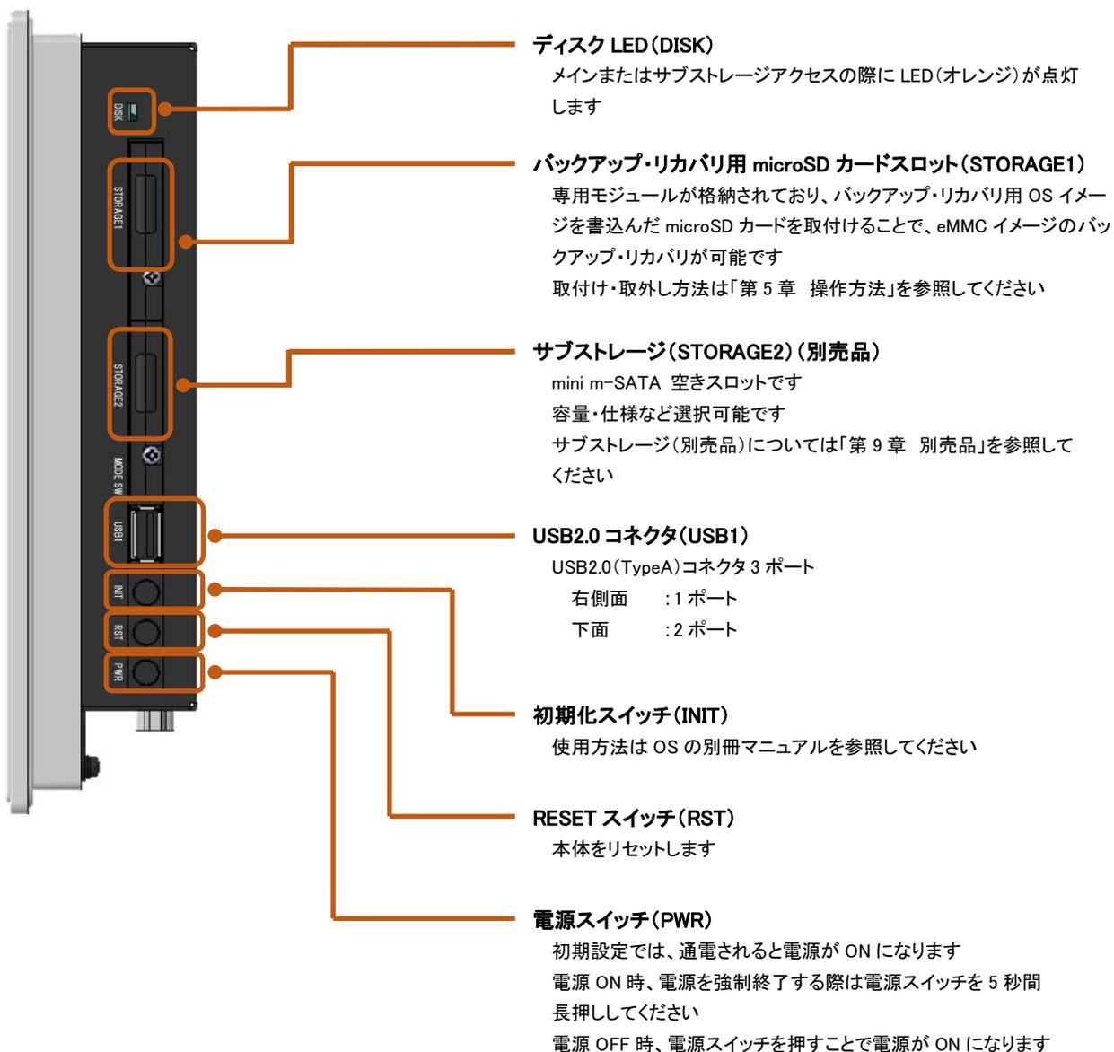
バックアップ・リカバリ用 microSD カードモジュールを外すと SIM カードスロットが、サブストレージを外すと MODE 設定スイッチがあります。
