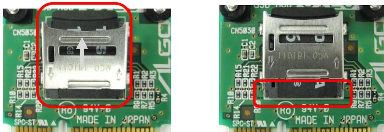
5. microSD カードモジュールを元の位置に差込み、ネジを回してとめます
