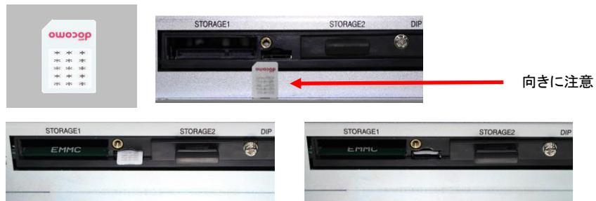
3. LTE 用 SIM カードを抜く際は、SIM スロットに差さっている LTE 用 SIM カードを奥まで押込むと LTE 用 SIM カードが SIM スロットから出てきます
