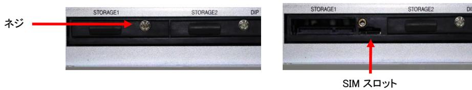
2. LTE 用 SIM カードの向きを確認し、SIM スロットに挿入します。カチッと音が鳴るまで押込んでください
