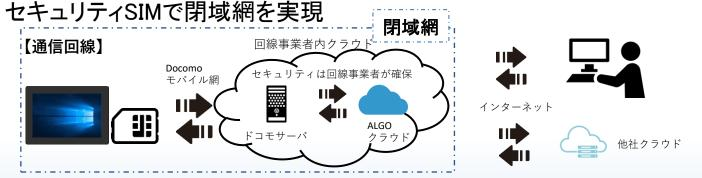
LTE/SIMからの通信回線はドコモ・モバイル網で接続本接続はインターネットには出ない専用線として接続されます通常の5G/4G/LTEにも対応
