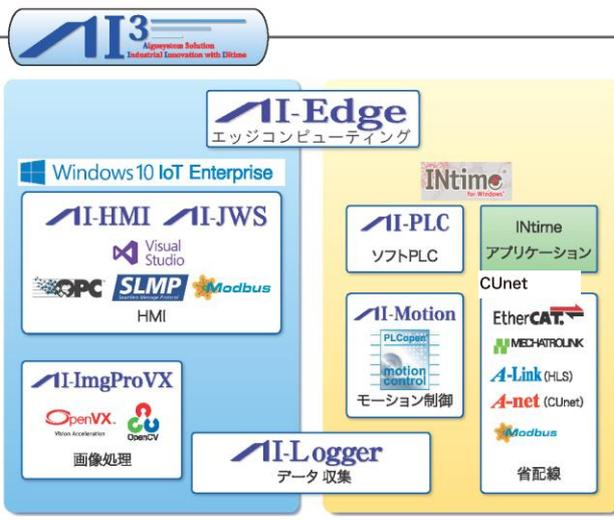
高機能表示器には、産業用PC1台で、Windows10に、操作・表示・データロギングができるAI3ソリューションを搭載。SLMPとModbus通信に対応し、PLCや温調器などと自動通信できます。
